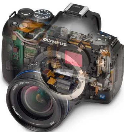
La cámara, como dispositivo captador de imágenes, capta y analiza la luz reflejada por los objetos, gracias a unos dispositivos electrónicos y ópticos la cuantifica y la envía a un sensor que contiene millones de pequeños dispositivos que captan los diferentes
